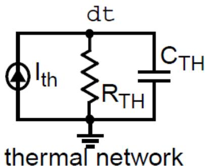
Figure 8.2: VBIC thermal network
